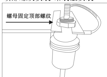
①在探头顶部螺纹用螺母固定
